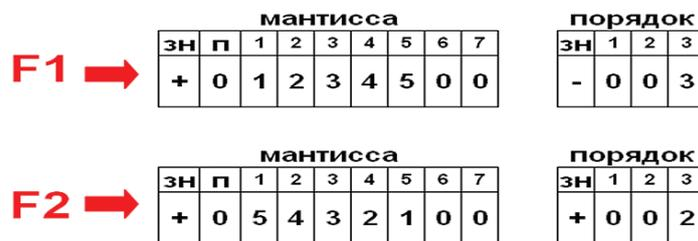
Рис. 1. Представление чисел в регистрах модельной машины
